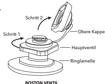
3. Beginnen Sie, Luft in das Kajak zu pumpen. Weiter aufblasen bis der gewünschte Luftdruck erreicht ist. NICHT ÜBERFÜLLEN. Sobald aufgeblasen, fest die Kappe jedes Ventils schließen.
