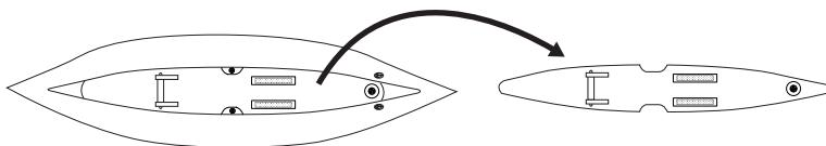
**REMARQUE:** N'oubliez pas de retirer le plancher du pont d'air DWF avant de le plier.
