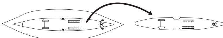
**HINWEIS:** Den DWF-Luftdeckboden vor dem Zusammenklappen zu entfernen.
