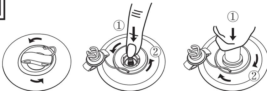
1. Ventildeckel durch Drehen gegen den Uhrzeigersinn lösen. Vergewissern Sie sich, dass das Ventil frei von Fremdkörpern, Sand oder Schmutz ist, bevor Sie es freigeben.
