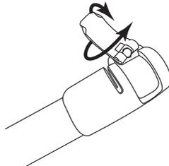
Asegúrese de que la línea central de la escala esté alineada con el indicador de la abrazadera
