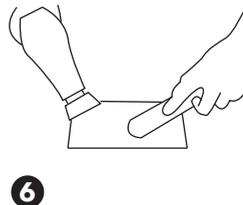
4. Appliquez de la colle sur le panneau et le patch en utilisant une brosse ou un autre applicateur. Assurez-vous que la colle est répartie uniformément et complètement sur la planche et le patch. Laissez sécher la colle pendant 5 minutes.
