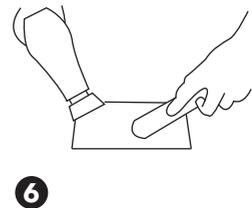
4. Kleber mit einem Pinsel oder einem anderen Applikator auf das Brett und das Pflaster auftragen. Vergewissern Sie sich, dass der Kleber gleichmäßig und vollständig über das Brett und den Flickens verteilt ist. Lassen Sie den Kleber 5 Minuten trocknen.
