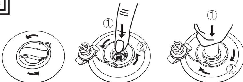
1. Libérez le couvercle de la vanne en le tournant dans le sens inverse des aiguilles d'une montre. Assurez-vous que la vanne n'a pas de sable ou de saleté avant de le relâcher.
