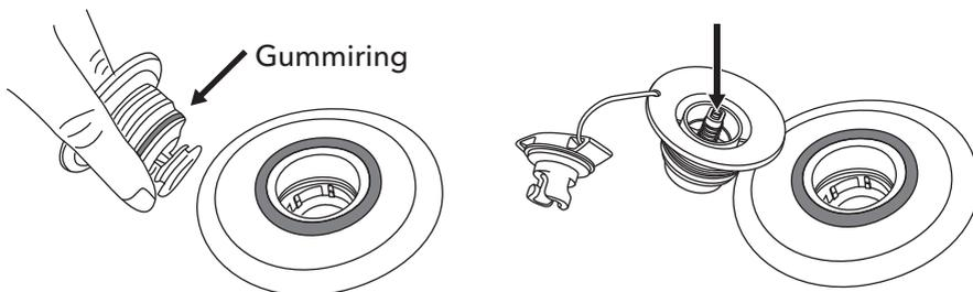
3. Überprüfen Sie den Gummiring, um sicherzustellen, dass er sich in der richtigen Position befindet, dicht um das Ventil liegt und sich dort keine Rückstände befinden.
